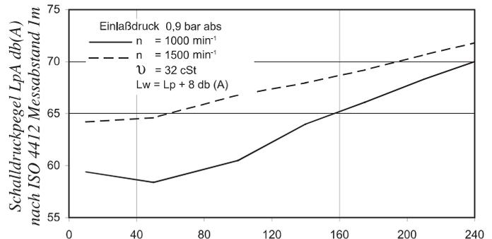
Kurve gilt bei gleichem Druck für P1 und P2.
