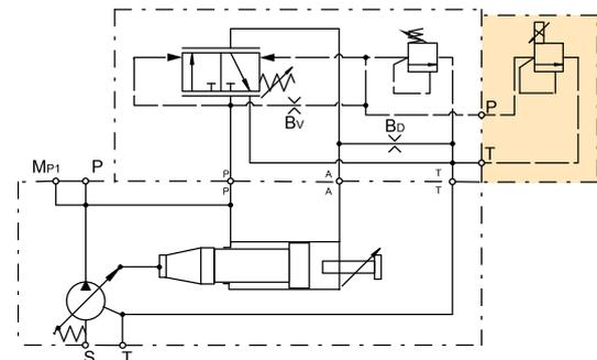
**Standarddruckregler ohne integriertes Druck-Pilotventil**
