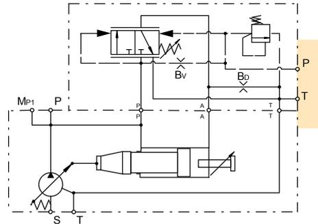
**Standarddruckregler mit elektrischer Entlastung,**
