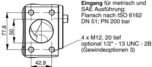
**Eingang** für metrisch und SAE Ausführung: Flansch nach ISO 6162 DN 51; PN 200 bar
