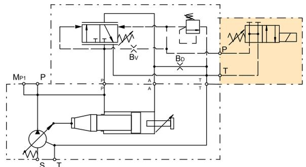
**Standarddruckregler mit proportional Pilotventil,**
