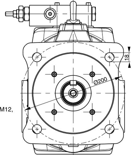
Die oben dargestellte Pumpe hat die **Anbauoption K** und die **Durchtriebsausführung T** (für Durchtrieb vorbereitet)
