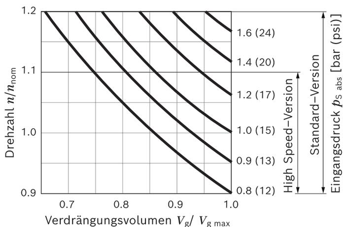
Bei Dauerbetrieb in Überdrehzahl über  $n_{nom}$  ist eine Lebensdauerreduzierung aufgrund von Kavitationserosion zu erwarten.
