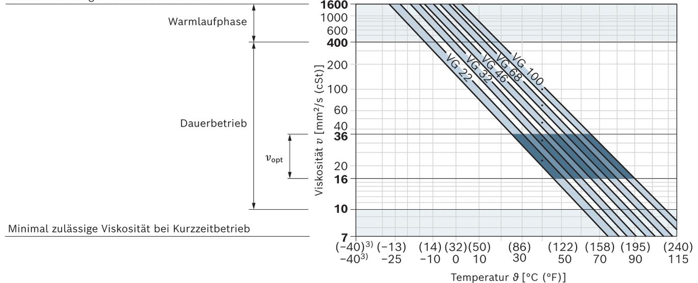
1) Entspricht z. B. bei VG 46 einem Temperaturbereich von +4 °C bis +85 °C (39 °F bis 185 °F) (siehe Auswahldiagramm)
