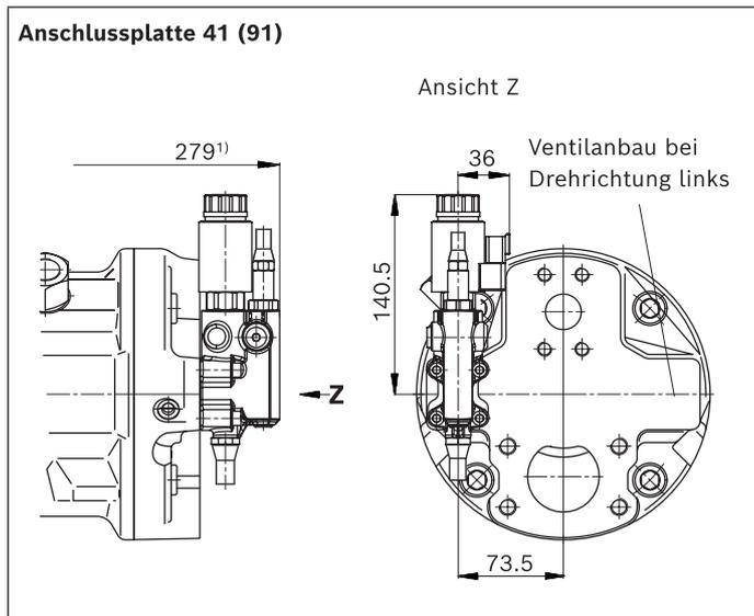
▼ **ED7. / ER7. – Elektro-hydraulische Druckregelung**
