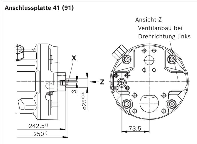
▼ **DG - Zweipunktverstellung, direktgesteuert**
