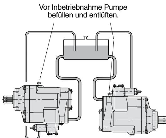
Abb. 8. Die VP1 soll immer tiefer liegen als der Ölstand im Tank. Zusätzlich muss die VP1-Pumpe gründlich durchgespült werden, damit gewährleistet ist, dass keine Luft mehr im Pumpengehäuse eingeschlossen ist.
