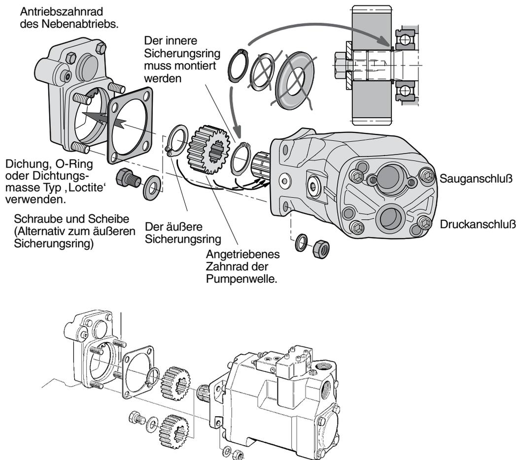
Abb. 6. Anbau der VP1 an einen Nebenabtrieb.
