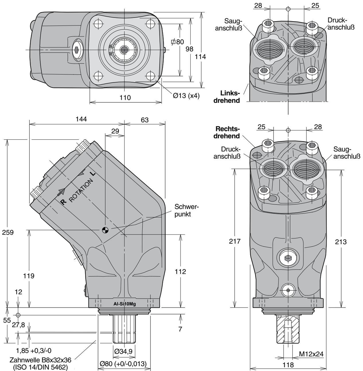
**Anschlüsse** (Anschlüsse mit BSP-Gewinde)
