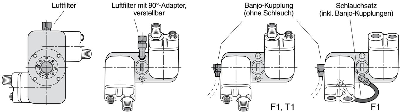
Luftfiltersatz (inkl. 90°-Adapter, verstellbar, und Dichtungen): Bestellnr. 378 1069.
