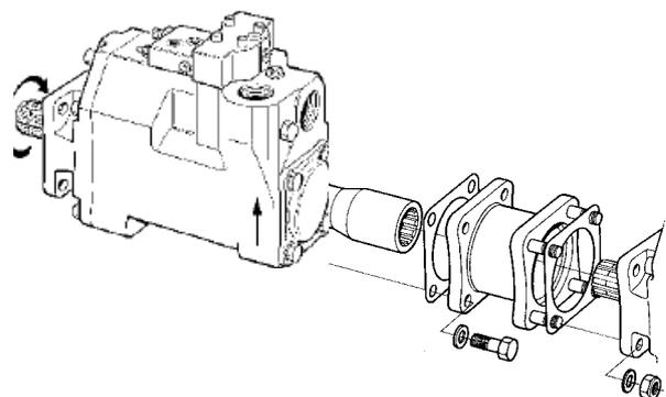
Abb. 3. Adaptersatz (P/N 379 7795) für Reihenschaltung zweier Pumpen.
