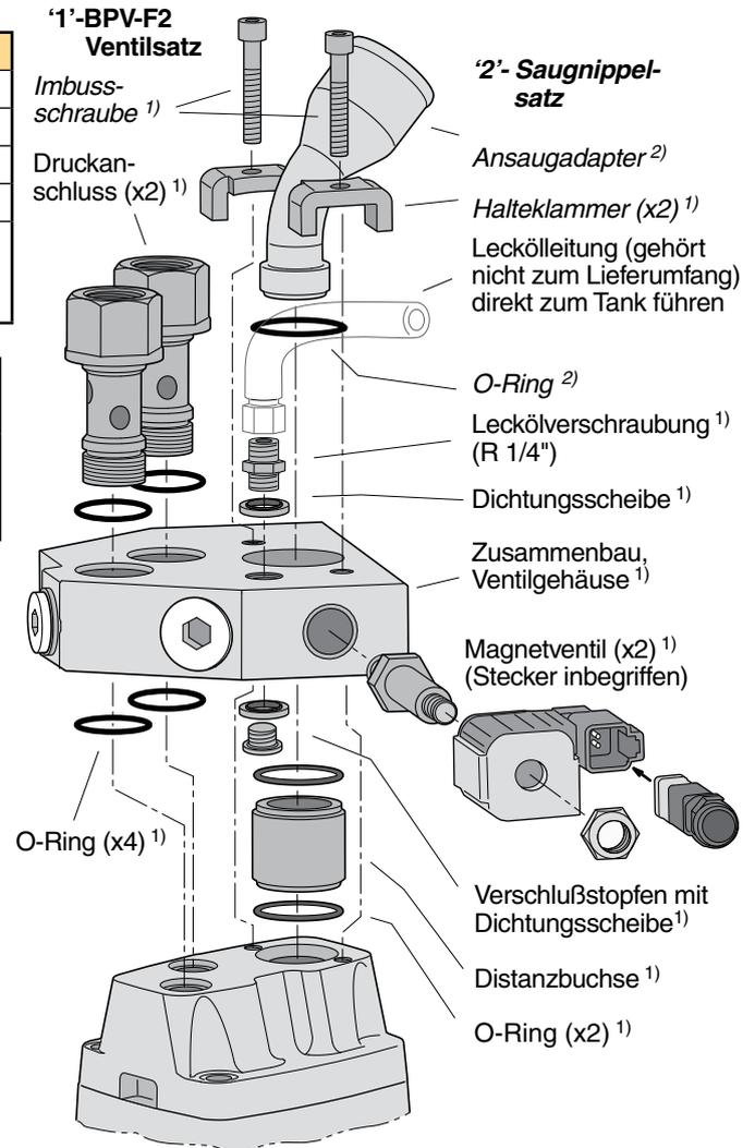
Montagezeichnung des BPV-F2 Bypass-Ventils ohne Nothandbetätigung (mit F2 Enddeckel).
