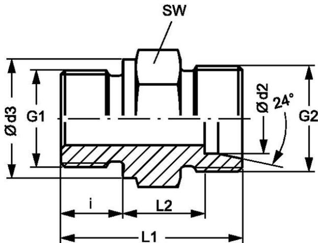
**Anschluss 1** metrisches Außengewinde zylindrisch
