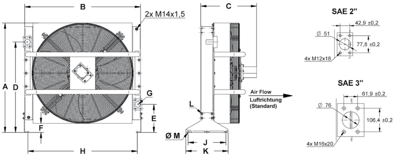
**STANDARD AUSFÜHRUNG DER ÖL/LUFTKÜHLANLAGE**
