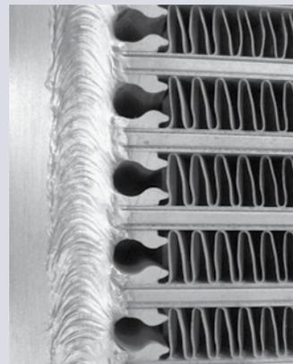
Bei den AKG-Line Kühlern kommt das flexible AKG-Lochprofil zum Einsatz. Damit werden örtliche Spannungsspitzen reduziert. Die Festigkeit und die Lebensdauer von Wärmeaustauschern wird deutlich erhöht.
