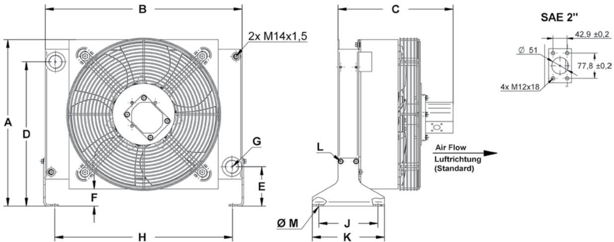
**KÜHLERABMESSUNG HR175 BIS HR490**
