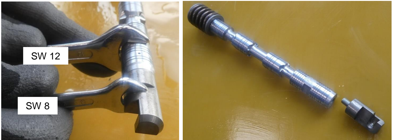
3-4: Abbau des Schieberendstückes
