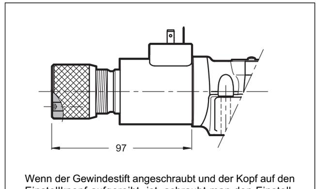
Wenn der Gewindestift angeschraubt und der Kopf auf den Einstellknopf aufgereiht ist, schraubt man den Einstellknopf bis zum Anschlag: in dieser Stellung ist die Steuerung nicht engagiert und das Ventil unbetätigt.
