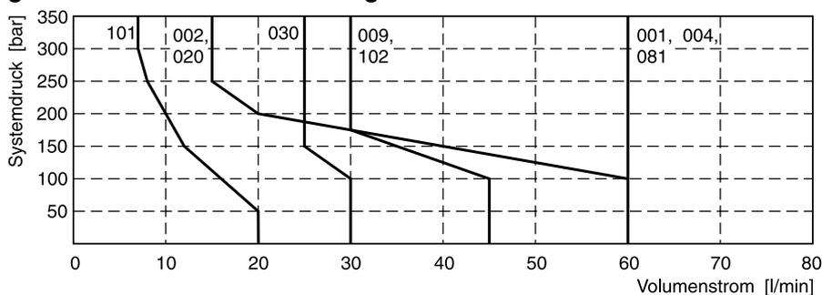
**Schaltleistungsgrenzen Soft Shift mit 2 DC-Magneten**
