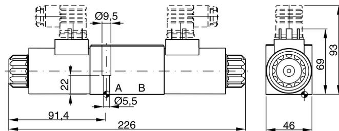
**Option 4N, arretierbare Kugelnothand (für alle Ausführungen verfügbar, nur für Gleichspannung)**
