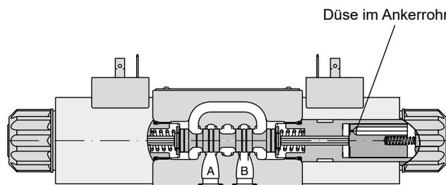
Für noch weiches Schalten können die Proportionalkolben 081, 082, 101 und 102 eingesetzt werden.
