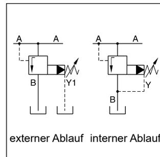
**Druckventile, manuelle Verstellung, vorgesteuertes Druckbegrenzungsventil, Serie R5V**
