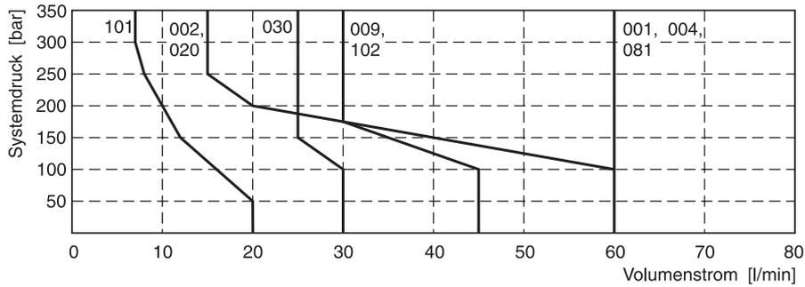
Schaltleistungsgrenzen Soft Shift mit 2 DC-Magneten
