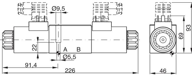
**Option 4N, arretierbare Kugelhohand (für alle Ausführungen verfügbar, nur für Gleichspannung)**
